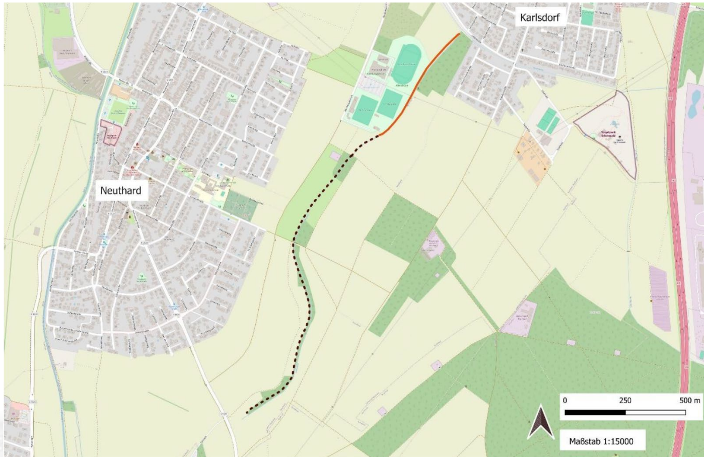
Abbildung 6: Mittels Hebebühne begutachtete Strecke der Vor-Ort-Begehung (rot), mittels Fernglases begutachtete Strecke (schwarz gestrichelt)
