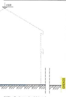
Ansicht NORDOST Nachweis der Wand in Grenznähe (Haus, NORDOST-Ansicht) (5,90 m + 5,85 m) / 2 x 0,4 = 2,33 m => mind. 2,50 m
